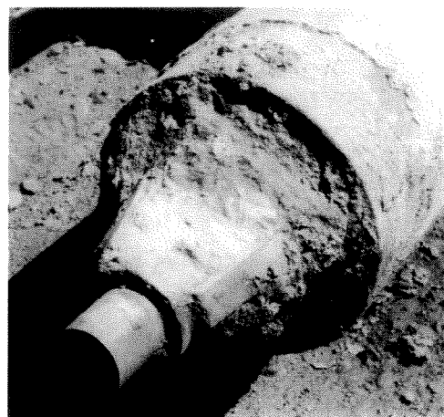
Bild 10. Uppdragen påle med vidhäftande jord
